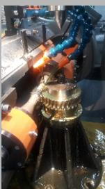
Нарезание червячных колес производится червячной фрезой методом радиального врезания или тангенциальной подачи.
