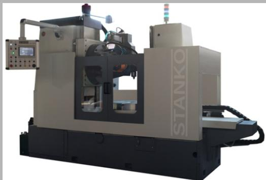
Станки зубофрезерные предназначены для нарезания цилиндрических и червячных зубчатых колес. Нарезание цилиндрических зубчатых колес производится червячной фрезой методом обкатки или дисковой модульной фрезой единичным делением.
